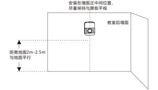
【说明】普通教室建议安装高度为2m-2.5m, 当安装在阶梯教室或其他类型的教室时, 安装高度 需根据实际情况进行调整,以监控画面能完全拍到教师的活动区域目视野边缘与黑板不能 有夹角为原则。
