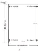
3. 将膨胀螺管插入孔内, 在上方的两个膨胀螺管上锁上自攻螺钉, 并预留5-10mm长度露在外。
