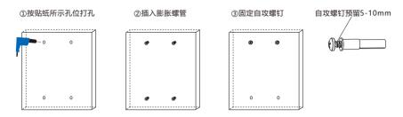
4. 将设备背面的葫芦孔卡进螺钉并将螺钉拧紧,然后拧紧下方的两个螺钉,固定设备。
